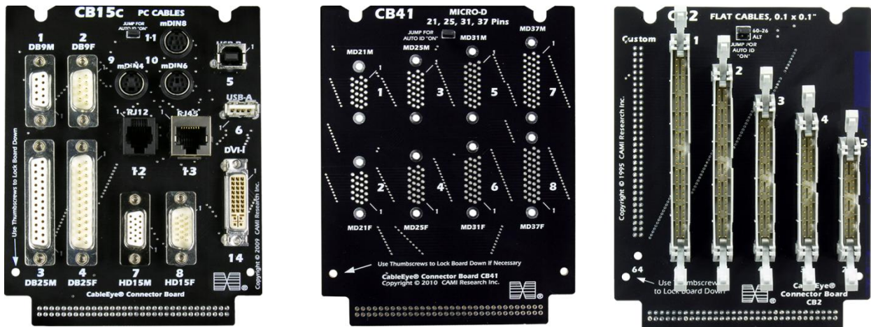
図1:コネクタタイプに制限の無いコネクタアダプタ基板は、コネクタのグループを実装されるか、カスタマイズ用にむき出しのままにしておく可能性があります。上の写真は、USB, D-Sub, ナノ-D, マイクロ-D, IDC ワイヤ・マウント・ソケットやその他の解決策の構成例です。
