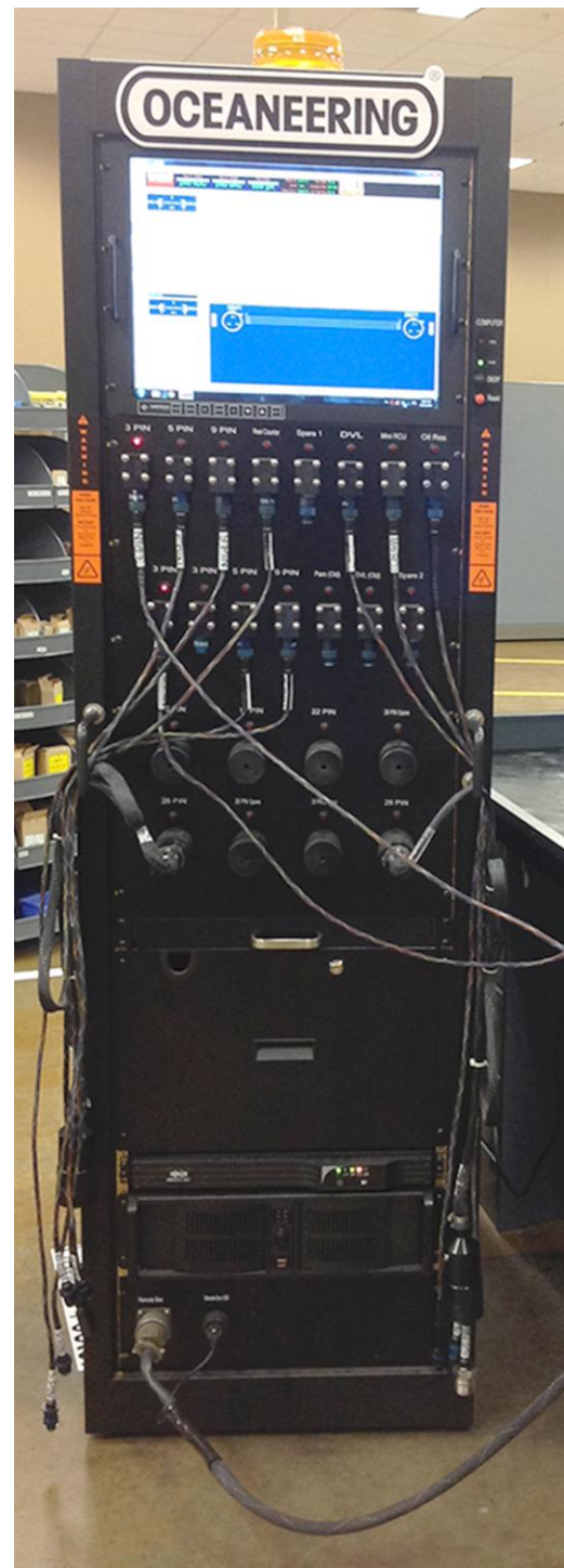
図4 : Oceaneering International, Inc. (LA) ROV ケーブルチェック用モバイルラックマ ウント式高圧ケーブルテストシステム
